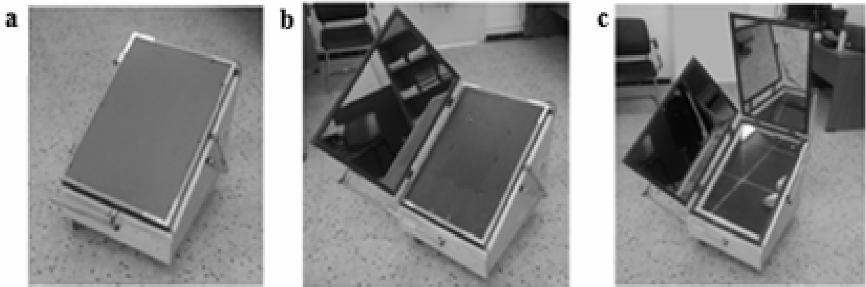
Fig. 2 – Vues du design du cuiseur solaire boîte à surface réceptrice inclinée réalisé à URAER, Ghardaïa, Algérie: a) CSB SRI avec deux réflecteurs additionnels pliés; b) CSB SRI avec réflecteur principal plié; c) CSB SRI avec deux réflecteurs en état fonctionnel.
